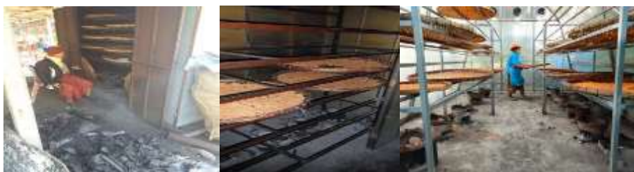
ภาพที่ 7 การใช้เตาถ่านในการทำแห้งขนมนางเล็ดร่วมกับพลังงานแสงอาทิตย์และตัวอย่างเขม่าควันฝุ่นละออง
