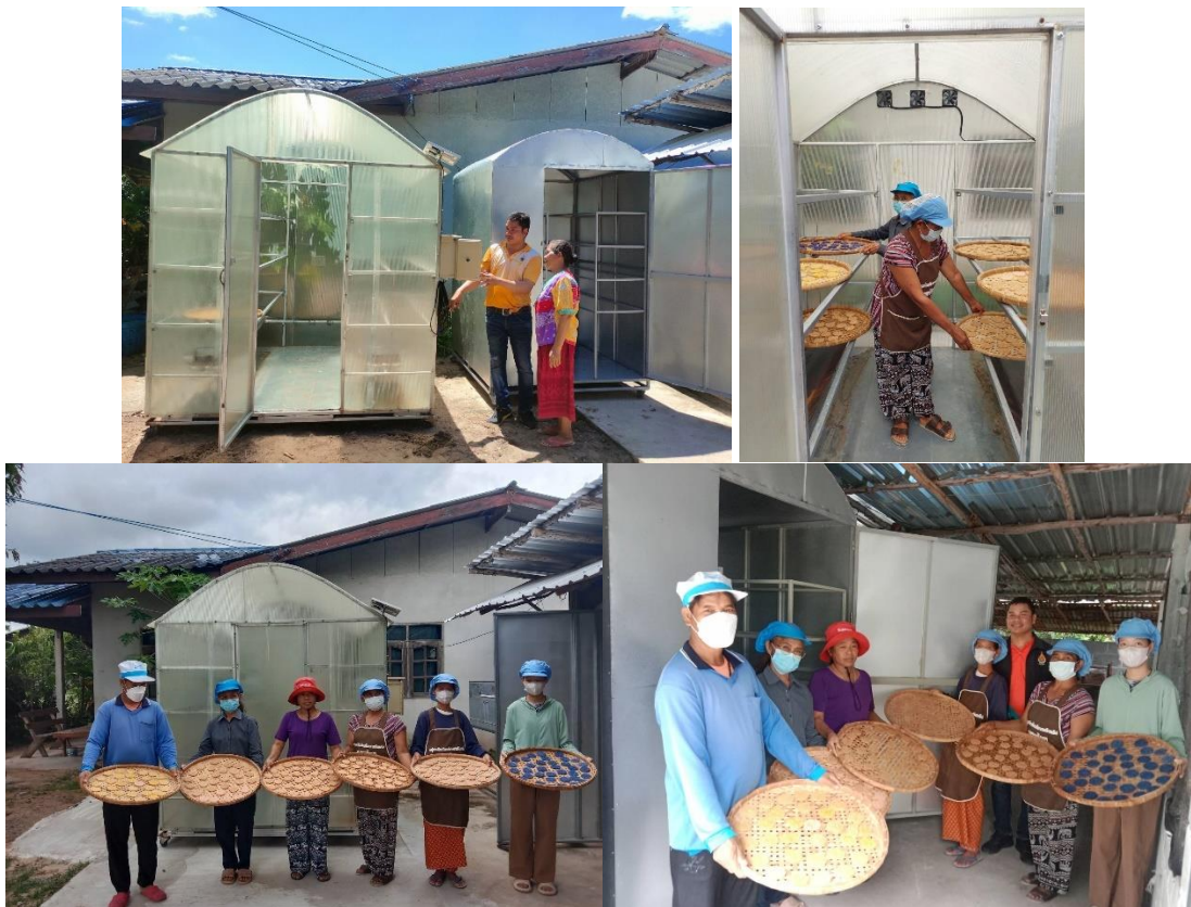
ภาพที่ 7 โรงอบแห้งขนมนางเล็ดด้วยพลังงานแสงอาทิตย์และพลังงานชีวมวล
