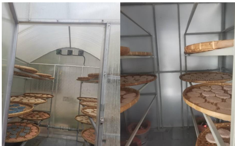
ภาพที่ 8 การใช้งานโรงอบแห้งขนมนางเล็ดด้วยพลังงานแสงอาทิตย์และพลังงานชีวมวล
