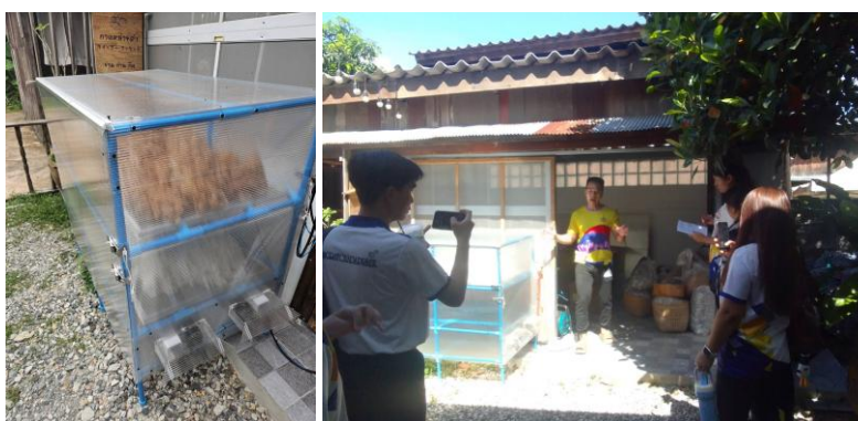
ภาพที่ 4 การนำปุ๋ยฝ้ายเข้าตู้อบแห้งลดความชื้นเพื่อควบคุมคุณภาพป้องกันเชื้อรา
